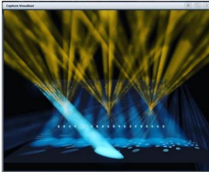
Ab Titan Version 10 ist Capture als Visualiser in die Software integriert. Damit wird der alte Avolites-Visualiser (das Drahtgitter-Modell) ersetzt; dieser ist aber noch über das Fenster [Legacy Visualiser] erreichbar.
