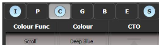
Oberhalb der Walzendarstellung für die Attribute auf dem Touch Wing wird angezeigt, welche Attributgruppe gerade bearbeitet wird (grau umrahmt); im Programmierspeicher befindliche Attributgruppen werden hellblau hinterlegt. Im gezeigten Beispiel ist die Farbe (Colour) gerade in Bearbeitung, und Intensity und Special wurden bereits bearbeitet.
