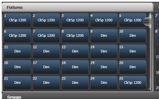
Geräteschaltflächen werden entweder seitenweise – mit gesonderten Tasten zur Umschaltung der Seiten – oder mit einer Schiebeleiste zum Wechseln angezeigt. Mit der Schaltfläche [Pages Show/Hide] rechts im Touchscreen lässt sich zwischen den beiden Darstellungsarten umschalten. Zwischen einzelnen Seiten der Anzeige lässt sich jederzeit wechseln.
