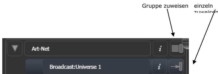
Zum Zuordnen eines Knotens zu einer Linie klicken Sie auf die Pfeil-Schaltfläche des Knotens (damit wird der Knoten markiert) und dann auf die gewünschte DMX-Linie
