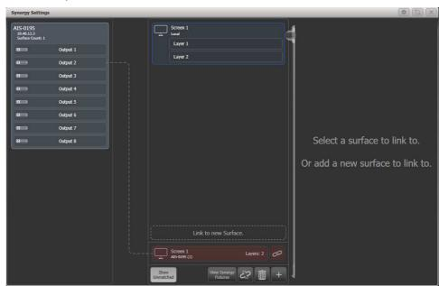
Sind die Surfaces verknüpft, so wird dies über eine farbige Linie zum Server angezeigt, und das nicht verknüpfte Surface unten verschwindet.
