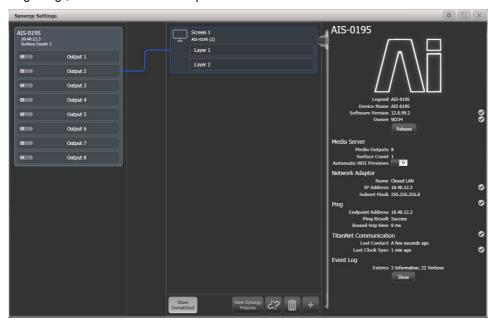
Das Surface lässt sich auch mit mehreren Ai-Outputs verknüpfen, wenn man z.B. den gleichen Content auf mehreren Outputs verwenden will. Dazu klickt man auf das Surface in der Mitte und danach links auf den zusätzlichen Output.
