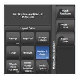
Im Layout-Editor lassen sich Geräte auch skalieren, um die relative Größe an die tatsächlichen Größenverhältnisse anzupassen. Dazu klickt man auf den Kontext-Button [Position and Angle], bis dieser [Fixture Scale] zeigt. Skaliert man Geräte mit Zellen sehr klein, so verschwinden die einzelnen Zellen, und alle Zellen arbeiten synchron.
