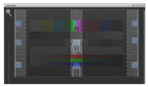
**Position Overlay:** ist diese Option aktiviert, so wird, sobald ein Gerät in Titan ausgewählt ist, dessen Position auf dem Ai-Output durch dünne Linien angezeigt, womit eine noch genauere Positionierung möglich ist.
