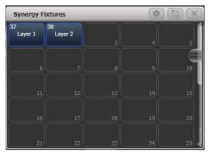
Durch Anklicken lassen sich einzelne oder mehrere Layer auswählen, wie man auch sonst Dimmer oder Movinglights zum Steuern auswählt. Sind Layer ausgewählt, so kann man im Attribut-Editor oder einfach mit den Attributtasten und Wheels Medien und Effekte steuern, die darauf angezeigt werden. Genauso lassen sich auch Paletten oder Playbacks speichern, wie das mit anderen Fixtures gewohnt ist. Es wird im Abschnitt 12.2.3 auf den folgenden Seiten näher erläutert.
