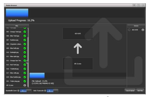
Die Dateien werden schnellstmöglich übertragen, und der Übertragungsfortschritt wird angezeigt. Dabei kann das Netzwerk stark ausgelastet und damit verlangsamt werden. Um dies zu vermeiden, kann unten der Schalter "Bandwidth Saver" (Bandbreite sparen) aktiviert werden. Damit wird der Upload verlangsamt, und das Netzwerk wird weniger stark ausgelastet.
