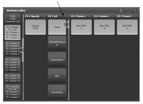
Bei den Fx (Effekt)-Attributen werden die Namen der Effekte direkt vom Ai-Server bezogen, so dass man wirklich das sieht, was auf dem Server angewählt ist. Dies ist auch bei Plugins für generativen Content der Fall, deren Namen man selbst bestimmt.
