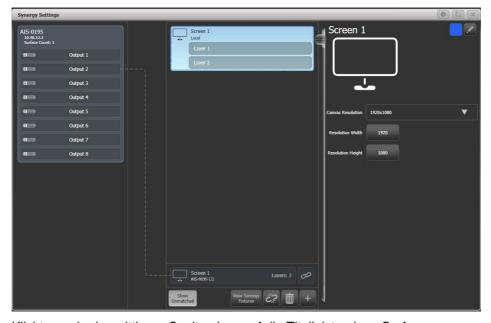
Klickt man in der mittleren Spalte oben auf die Titelleiste eines Surfaces, so werden rechts die entsprechenden Optionen angezeigt. Damit lässt sich die Auflösung einstellen, wahlweise per Auswahl aus einer Liste oder per numerischer Eingabe. Ganz rechts oben kann man mit dem farbigen Button das Halo des Surfaces ändern sowie mit dem Stift-Icon die Legende (Bezeichnung) bearbeiten (beides ist auch wie gewohnt per [Set Legend] möglich).
