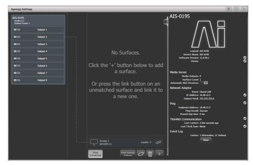
Links sind die verfügbaren Ai-Server mit ihren Outputs aufgeführt. In der Mitte sind die in Titan angelegten Surfaces und Layer aufgeführt. Linien zwischen den Outputs und Surfaces zeigen die Zuordnung an. Unten tauchen die Surfaces auf, die zwar in Ai schon angelegt sind, aber noch nicht in Titan. Dieses sind die "unmatched" (nicht zugewiesenen) Surfaces.
