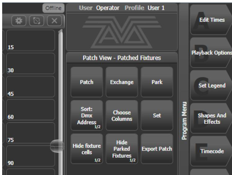
Mit den **Optionen für die Arbeitsfenster** (stilisiertes Zahnrad) können Größe und Position der Fenster auf verschiedene Standardwerte gesetzt und die Größe der Schaltflächen sowie die Schriftgröße für jedes Fenster getrennt eingestellt werden. Die verfügbaren und angezeigten Elemente hängen vom jeweiligen Fenster sowie der Einrichtung des Pultes ab, etwa davon, ob ein externer Bildschirm angeschlossen ist.
