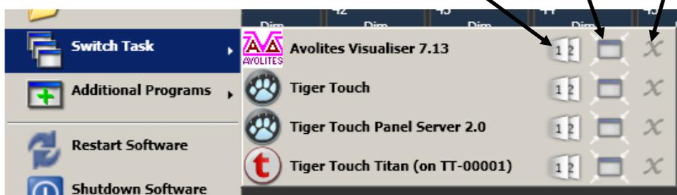
**Additional Programs** dient zum Aufruf einiger Diagnoseprogramme, die dem Avolites-Support die Fehlersuche ermöglichen.
