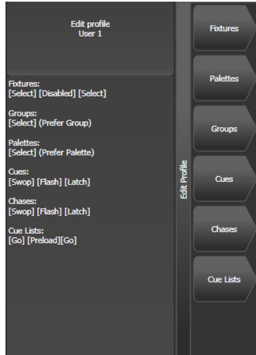
**Fixtures:** die blaue, graue sowie 'touch'-Taste lassen sich als 'Disabled' (deaktiviert), 'Select' (Auswahltaste), 'Flash', 'Swop' und 'Latch' (Einrasten) konfigurieren. Die 'Latch'-Funktion wirkt wie das
