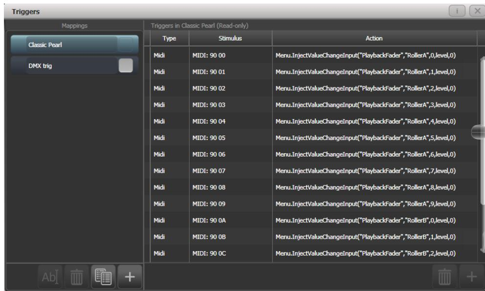
Zum Löschen eines Trigger aus der Zuordnung wählen Sie diesen und betätigen die Schaltfläche mit dem Papierkorb-Symbol rechts unten.
