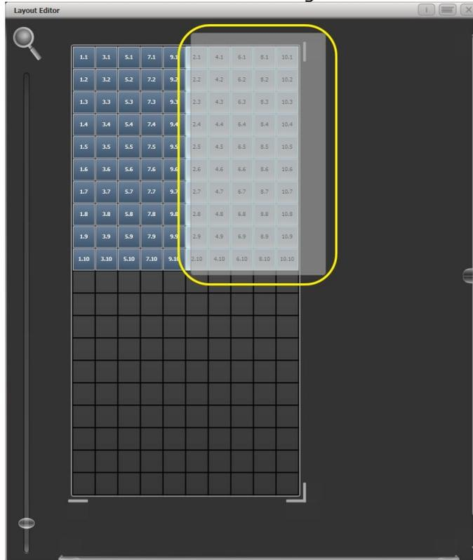
3> Ziehen Sie die Geräte so, dass Sie direkt unter den ungeraden (der linken Gruppe) positioniert werden.
