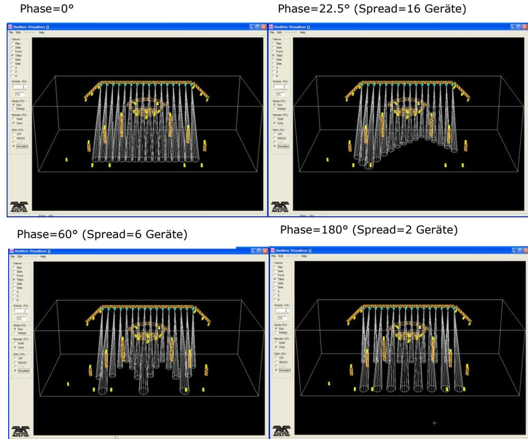
Im Display über dem linken Rad wird die Phase in ° (Grad) angezeigt. So sorgt etwa Phase=180° für eine Wiederholung jedes zweiten Gerätes, 90° jedes vierten Gerätes, 60° jedes sechsten Gerätes usw.
