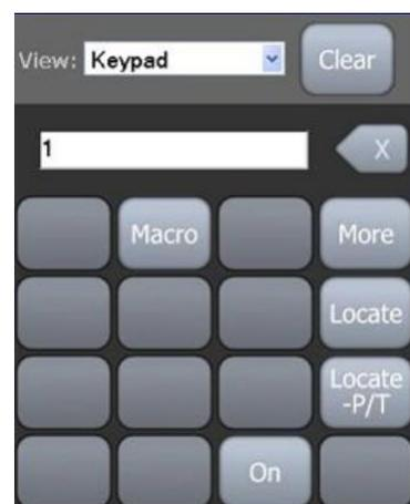
Mit der Macro-Taste lassen sich spezielle Funktionen der Geräte aufrufen, wie z.B. Reset, Lamp On, Lamp Off.
