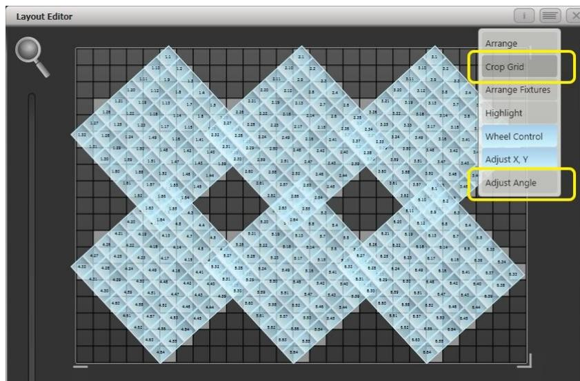
Hinter den nun gedrehten Zellen wird die ursprüngliche Anordnung hellgrau eingeblendet.
