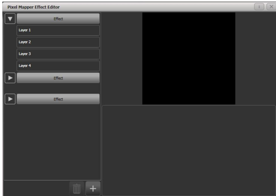
Klicken Sie unten auf die Schaltfläche [+], um einen Effekt zu erzeugen, und wählen Sie eine der verfügbaren Formen aus.
