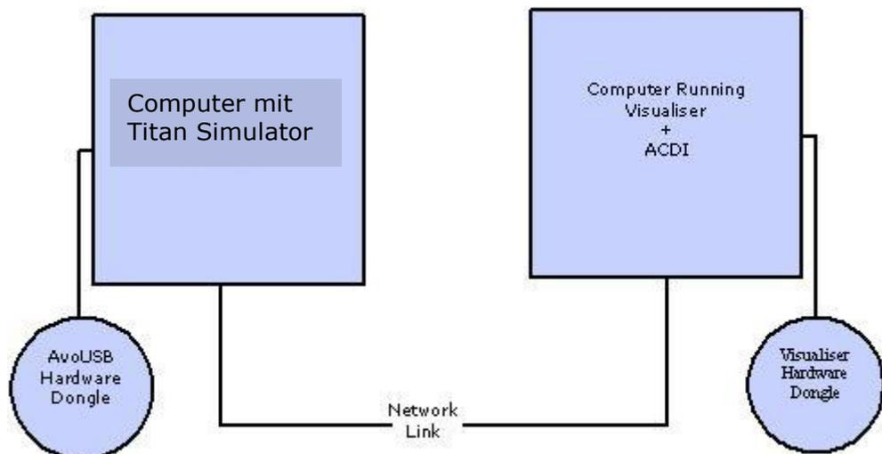
Zur Herstellung der Netzwerkverbindung benutzen Sie entweder einen Netzwerk-Hub oder ein Crossover-Kabel; in diesem Beispiel seien die beiden Computer mit einem Crossover-Kabel verbunden.
