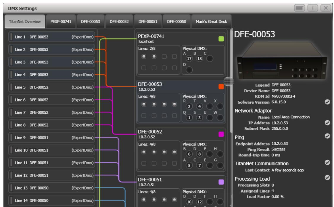
Links werden die max. 64 möglichen 'internen' Linien gezeigt. Rechts davon erscheinen die verbundenen Knoten/Nodes, wobei das Pult selbst ganz oben – als erster Knoten – erscheint. Für jeden Knoten wird angezeigt, welche Linie auf welchem Anschluss ausgegeben wird.
