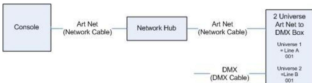
Verbinden Sie die Geräte mit normalem Netzkabel (RJ-45).
