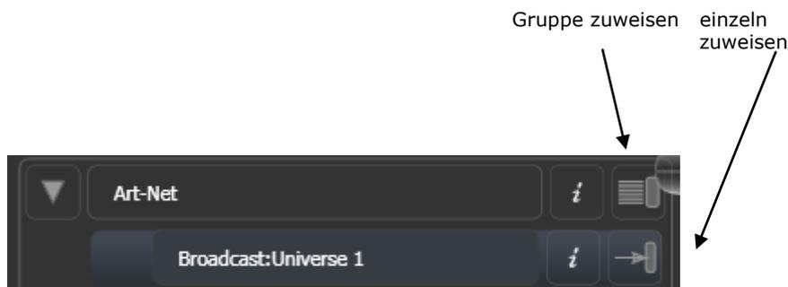
Zum Zuordnen eines Knotens zu einer Linie klicken Sie auf die Pfeil-Schaltfläche des Knotens (damit wird der Knoten markiert) und dann auf die gewünschte DMX-Linie.
