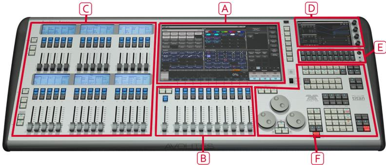
(A) Der **Touchscreen** zeigt Schaltflächen zur Auswahl von Geräten, Paletten und Gruppen. Ferner zeigt er Bezeichnungen der Playbacks, sowie – oben rechts – die aktuelle Menüseite und die Bezeichnungen der variablen Tasten.
