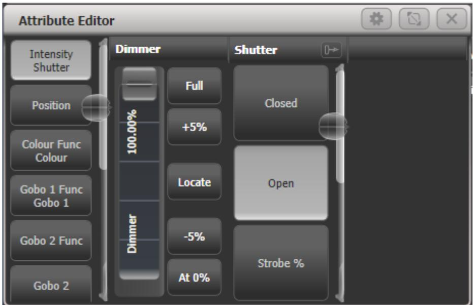
Speziell unterteilter Fader und Buttons für 0%, 100%, +5%, -5% sowie Locate (nur Dimmer).
