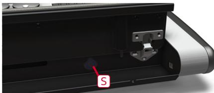
Die gepolsterte **Handauflage** kann geöffnet werden; innen ist nicht nur Stauraum für verschiedenste Utensilien, sondern (S) rechts der Hauptschalter, (R) links Anzeigen für Disk-Aktivitäten, sowie an den beiden Enden jeweils eine USB-Buchse.
