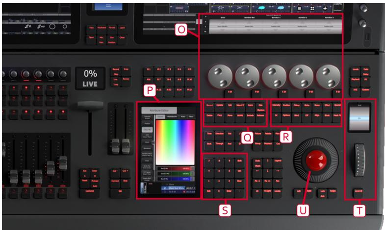
(O) Mit den **Drehreglern** (Encodern) werden sowohl Attribute der Geräte als auch Geschwindigkeit und Überblendung von Chasern eingestellt. Im Touchscreen oberhalb der Räder wird angezeigt, welche Parameter momentan mit welchem Rad verknüpft sind. Mit den Tasten ganz rechts neben den Encodern lassen sich andere Funktionen auf die Encoder legen, z.B. Fadezeiten, Details von Shapes, oder die Steuerung des Visualisers.
