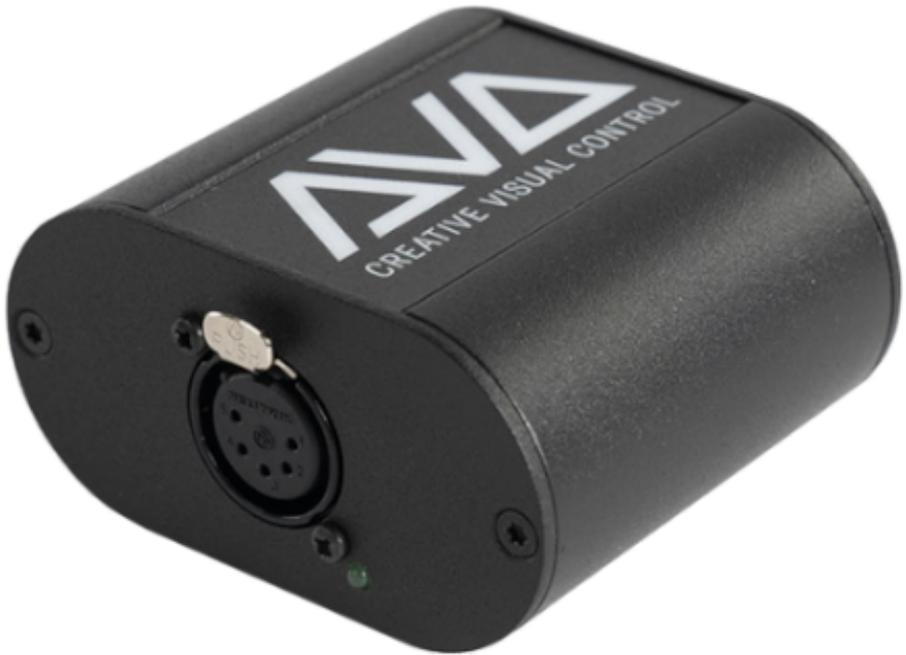
Der **T2** kann zwei DMX-Universen auf 5-poligen XLR-Buchsen sowie per sACN/ArtNet über den Netzwerkanschluss des Computers ausgeben und hat eine 3-polige XLR-Buchse als Audio/LTC-Eingang (symmetrisch, 600 Ohm Übertrager zwischen Pan 2 und 3, Pin 1 nicht verbunden). Außerdem erlaubt er die Verwendung von USB-MIDI-Geräten (per USB an den Computer angeschlossen, auf dem Titan läuft), etwa von Faderboards, und kann mit dem T3 Wing oder dem Titan Mobile Faderwing betrieben werden.
