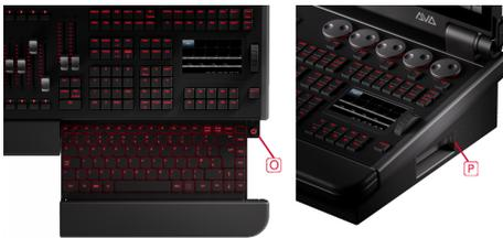
An der Vorderseite des Pultes befindet sich eine ausziehbare beleuchtete **Tastatur** z.B. für Legenden oder zum Eingeben von Suchbegriffen. Der **Einschalter** (O) ist rechts neben der Tastatur (sichtbar, wenn diese herausgezogen ist). Ein **USB-C-Anschluss** (P) z.B. für USB-Sticks befindet sich in der Mulde des rechten Griffs.
