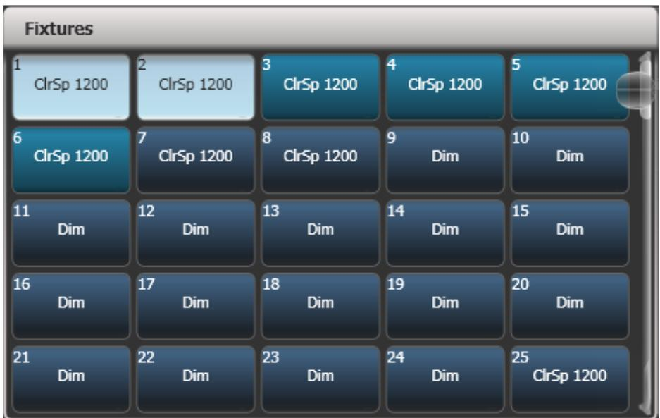
1. Betätigen Sie die Buttons/Tasten der gewünschten Geräte. Die Schaltflächen erscheinen daraufhin hellblau, bei auf Tasten gepatchten Geräten leuchten die LEDs hell auf.
