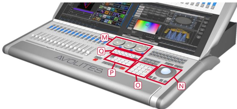
(M) Mit den **Encodern** (Drehreglern) werden sowohl Attribute der Geräte, als auch Geschwindigkeit und Überblendung der Sequenzen eingestellt. Im Touchscreen oberhalb der Räder wird angezeigt, welche Parameter momentan mit welchem Rad verknüpft sind.
