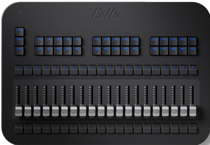
Zur Anzeige der Belegung der Fader und Tasten auf dem Wing gibt es das Fenster “Mobile Wing”. Um dieses zu öffnen, drücken Sie zweimal auf <View/Open> und wählen “Mobile Wing”. Mit den Kontext-Buttons kann man verschiedene Anzeigarten dieses Fensters wählen, z.B. alles zusammen, nur die Fader, nur die Tasten etc.
