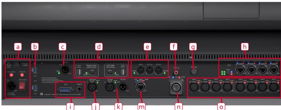
(a) Netzspannungseingang (PowerCON TRUE1), Hauptschalter und Unterbrecher für die USV. Schalten Sie das Pult nicht mit dem Hauptschalter aus, sondern fahren Sie es mit dem Einschalter auf der Vorderseite ordnungsgemäß herunter.
