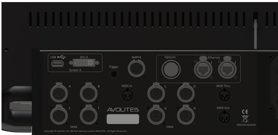
Sämtliche für das Pult erforderlichen Anschlüsse befinden sich auf der Rückseite.
