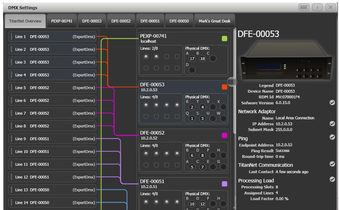
Links werden die max. 64 möglichen 'internen' Linien gezeigt. Rechts davon erscheinen die verbundenen Knoten/Nodes, wobei das Pult selbst ganz oben – als erster Knoten – erscheint. Für jeden Knoten wird angezeigt, welche Linie auf welchem Anschluss ausgegeben wird. Ein Klick auf den Ausgangsbereich des jeweiligen Knoten öffnet dessen Detailansicht.
