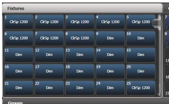
Geräteauswahltasten werden entweder seitenweise – mit gesonderten Tasten zur Umschaltung der Seiten – oder mit einer Schiebeleiste zum Wechseln angezeigt. Mit der Schaltfläche [Pages Show/Hide] rechts im Bildschirm lässt sich zwischen den beiden Darstellungsarten
