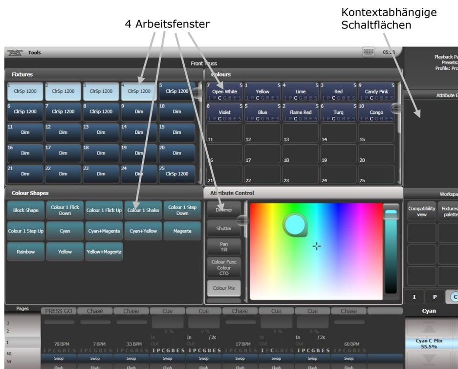
Bis zu vier Arbeitsfenster lassen sich auf dem Bildschirm in einer 2x2 Anordnung anzeigen; ist eine größere Anzeige erforderlich, so lassen sich die Arbeitsfenster auf doppelte Größe oder auf den gesamten Bereich ausdehnen. Ebenso können sie auf den externen Bildschirm verschoben werden, der weitere 4 Arbeitsfenster zeigen kann. Einige Kombinationen von Größen und Positionen sind hier gezeigt:
