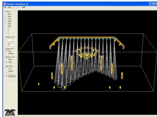
Ein Shape ist eine automatische Folge von Werten, die auf jedes Attribut eines Gerätes angewendet werden kann. Ein Kreis-Shape (circle) etwa, angewendet auf Pan und Tilt, sorgt für eine Kreisbewegung des Gerätes. Dabei lässt sich das Zentrum des Kreises, die Größe sowie die Geschwindigkeit der Bewegung beeinflussen.
