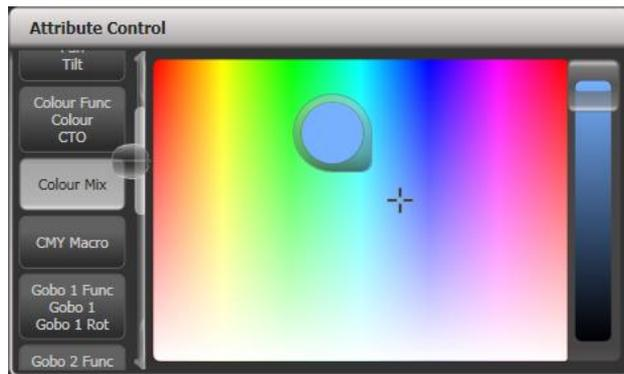
Für stufenlos einstellbare Attribute (z.B. Dimmer) erscheint ein Regler im Display, sobald die Schaltfläche gedrückt gehalten wird. Der Regler lässt sich einfach durch Bewegen des Fingers verstellen.
