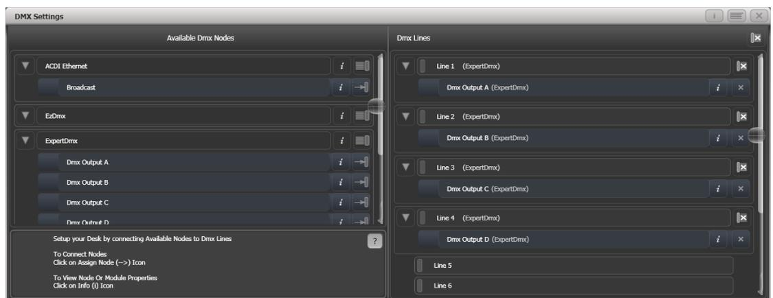
Die Knoten (links) lassen sich mit den Pfeilen einzeln den Linien zuordnen; mit dem Pfeil-Symbol der Knotengruppe werden gleich alle gleichartigen Knoten zugewiesen. Zur Zuweisung der 4 DMX-buchsen
