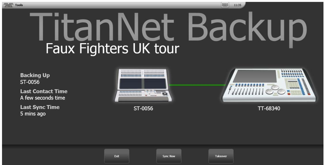
Eine grüne Linie zwischen den Pulten markiert eine stabile Verbindung. Verbindungsprobleme werden durch eine rote Linie angezeigt. Während laufender Synchronisationsvorgänge erscheint die Linie in blau.
