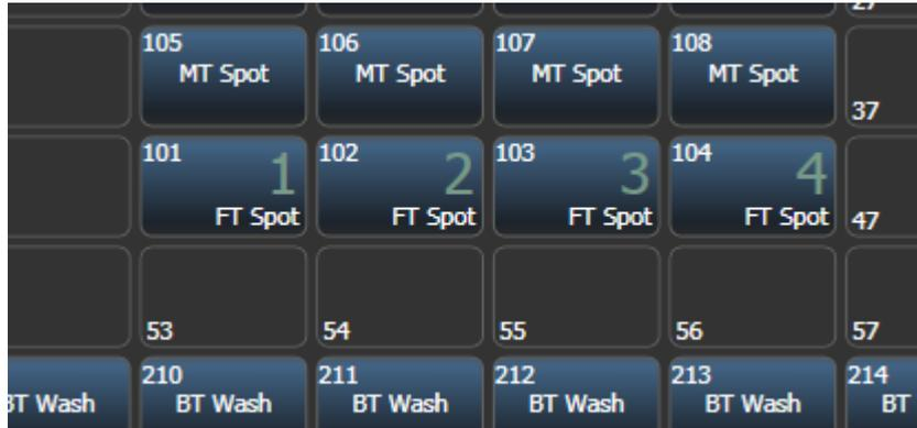
Um die Reihenfolge zu ändern, schalten Sie [Auto Increment] auf On, und klicken dann in der gewünschten Reihenfolge auf die Geräte. Wird doppelt auf ein Gerät geklickt, so wird mit einem X angezeigt, dass es nicht Teil der Reihenfolge ist.
