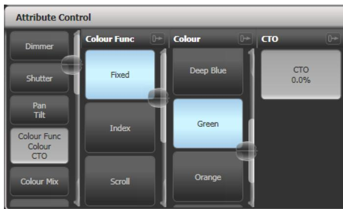
Der übrige Bereich des Fensters enthält Schaltflächen und Steuerelemente, um den Attributwert einzustellen. Bei Attributen mit festen Werten (Gobos, Farben etc.) gibt es für jeden einzelnen Festwert eine Schaltfläche; dies ermöglicht eine deutlich schnellere Auswahl als mit den Rädern.
