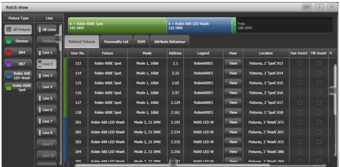
In der Spalte **Fixture type** sind die verschiedenen Gerätetypen aufgelistet; dabei hat jeder Typ eine andere Farbe. Beim Klick auf diese Buttons werden sämtliche Geräte dieses Typs ausgewählt.
