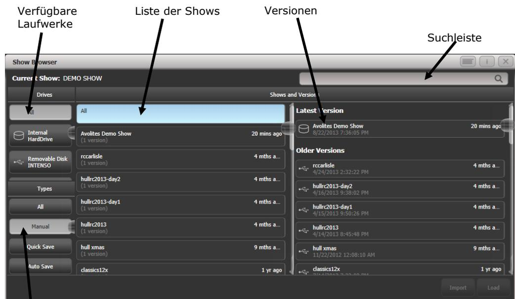
Links oben kann man das zu verwendende Laufwerk wählen. Links unten lässt sich die Anzeige filtern, etwa um nur manuelle oder nur Autosaves anzuzeigen. Rechts werden die verschiedenen vorhandenen Versionen der gefundenen Show angezeigt; damit kann man schnell und einfach zu einem früheren Programmierstand wechseln.
