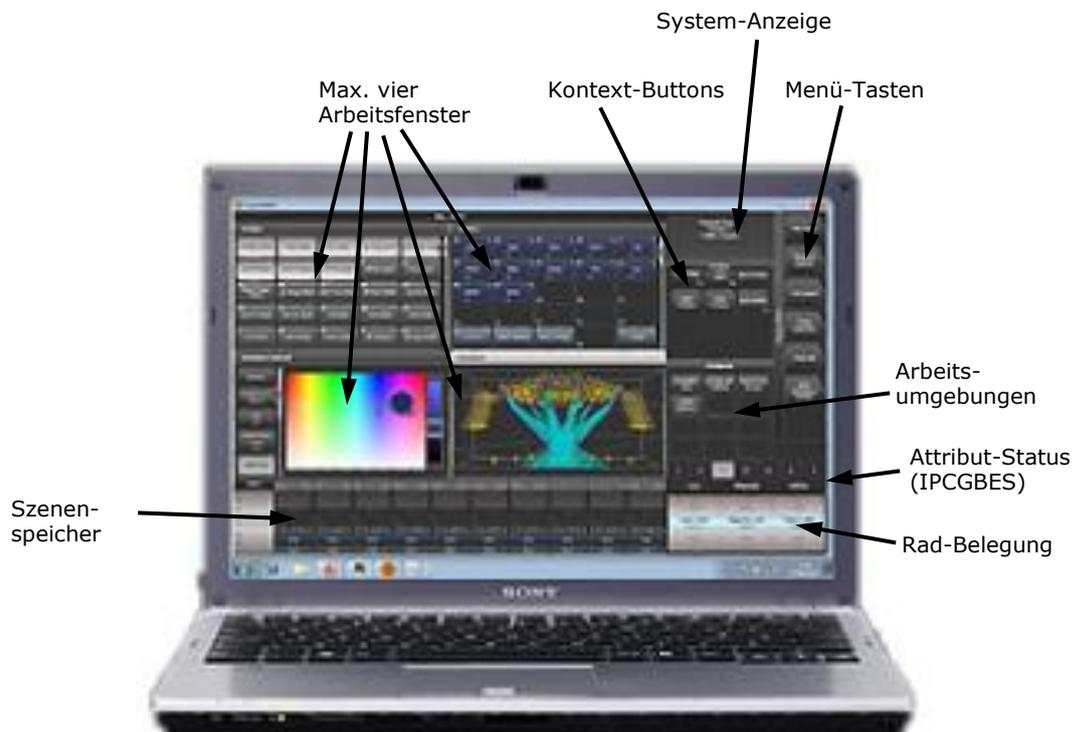
Bis zu **vier Arbeitsfenster** können auf dem Bildschirm angezeigt werden; diese enthalten jeweils Buttons (Schaltflächen) zur Auswahl von Geräten, Paletten, Gruppen, Shapes, Attributen etc. Auch der Visualiser wird in einem solchen Fenster angezeigt.
