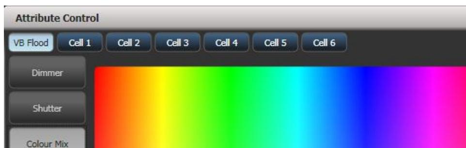
Ebenso können Sie dazu die Unfold-Funktion verwenden: drücken Sie <Unfold> und dann die entsprechende Geräteschaltfläche. Daraufhin werden im Gerätefenster Schaltflächen für die einzelnen Zellen angezeigt.
