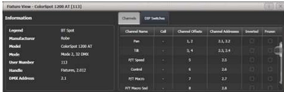
Wenn die Geräte über DIP-Schalter adressiert werden, so zeigt dieses Fenster die entsprechende Schalterstellung im Reiter ‚DIP-Switches‘.
