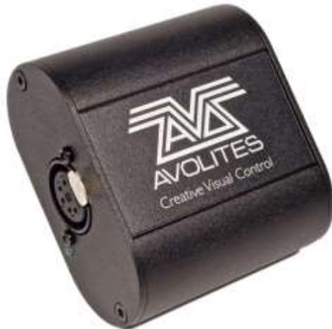
Der T2 kann zwei Universen auf 5-poligen XLR-Buchsen ausgeben und hat einen Audio/LTC-Eingang. Außerdem erlaubt er die Verwendung von USB-MIDI-Geräten, etwa von Faderboards, und kann mit dem Titan Mobile Faderwing betrieben werden.
